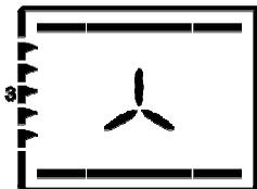
風扇確保底部和頂部發熱的空氣快速地在焗爐內均勻分佈。使用一個托盤烹調。
